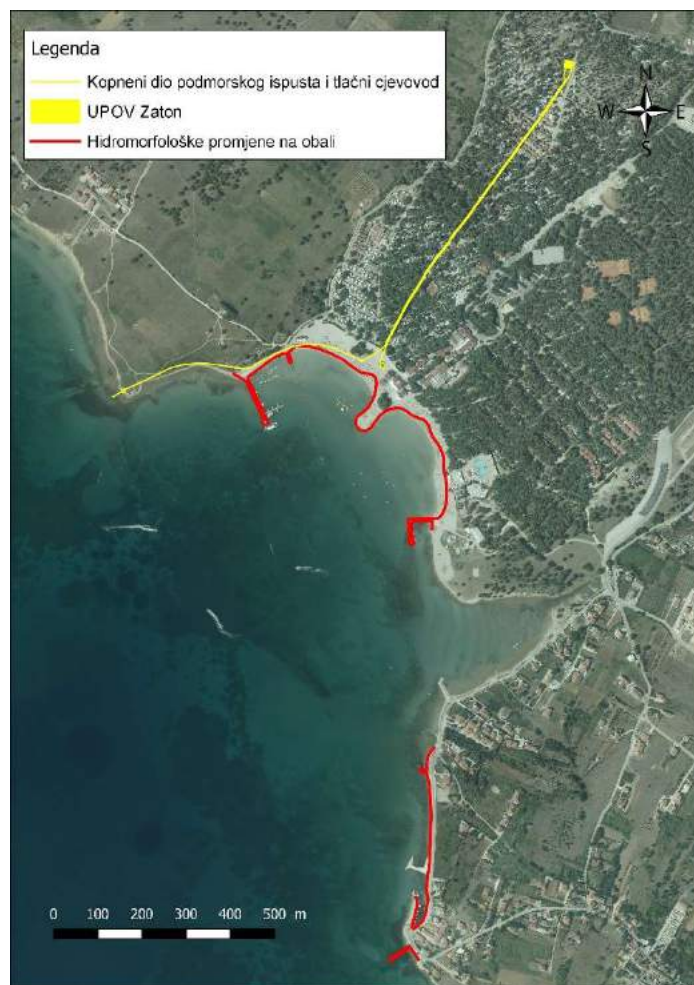
Grafički prikaz 13: Postojeće hidromorfološke promjene na priobalnom vodnom tijelu 0423-KVJ na širem području TN Zaton (izvor: Hrvatske vode)
